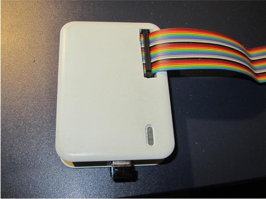
8. Jetzt das Gehäuse für die LED und Sensoranschlüsse fertigen. Die Kerbe für die Flachbandkabeleinführung auf der linken Seite nicht vergessen!
