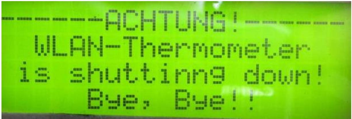
Wenn das Blinken am Raspi aufgehört hat (Grün für SD-Zugriff und ggf. Blau am WLAN-Modul), kann der Strom gefahrlos abgeschaltet werden.
